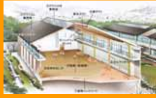
< 東京都目黒区立目黒中央中学校 > 太陽熱を利用した床暖房の概念図
