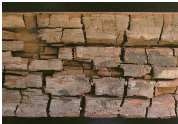
図7-3 針葉樹材でよく見られる褐色腐朽材の外観 2)
