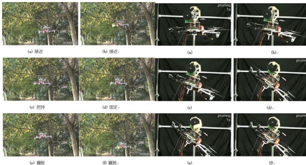
図 16 枝への接近、固定と枝からの離脱 図 17 揺動回転を用いて枝の切り落とし
