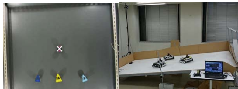
図 18 障害物回避制御実験 図 19 斜面上フォーメーション制御実験
