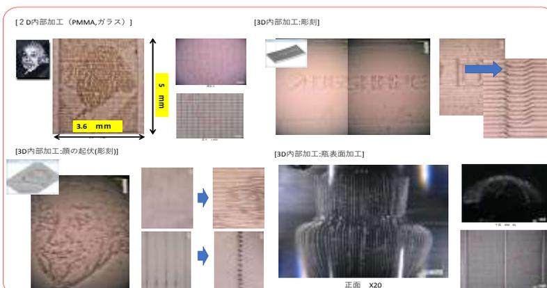
図3 開発したfsUSPL加工機を用いたアクリルおよびガラスへの加工例<sup>\*1,\*4</sup>
