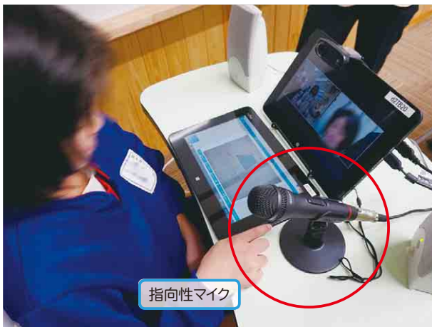
▲複数の遠隔会議システムを同時に使用するとハウリングが発生しやすくなるので、指向性マイクやヘッドセットなどを利用して、ほかのグループの会話がマイクに入らないようにする必要がある
