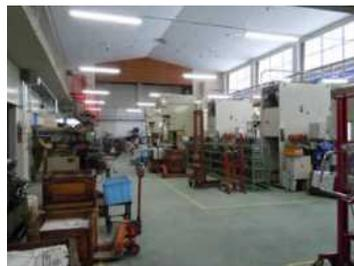
校舎の1階部分と体育館にかけて、製造ラインを確保。体育館は高い天井高と柱のない広いスペースを活かして、大型製造機械を設置するなど、作業の効率性を考慮したレイアウト配置となっている。
