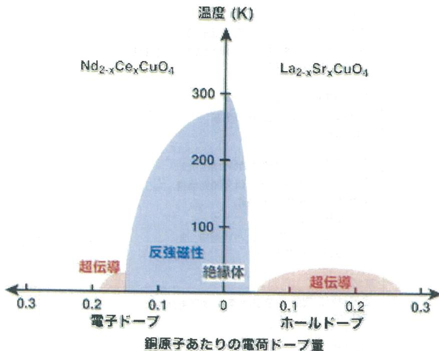
図4 銅酸化物超伝導体における銅原子あたりの電荷ドープ量と温度の関係。
