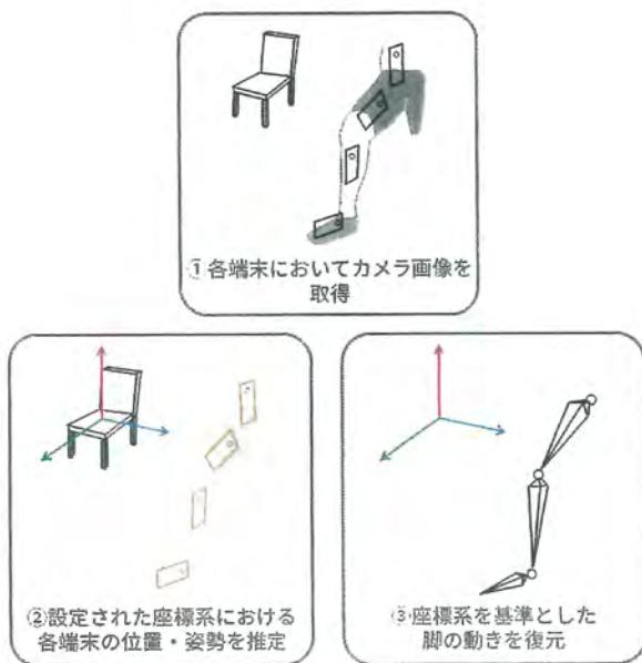
図 5 計測システムの概略図
