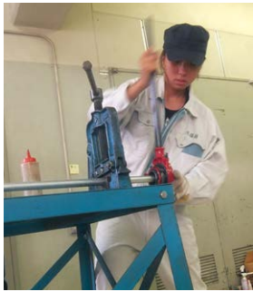
設備工業に関する学科の鋼管にねじを切る実習
