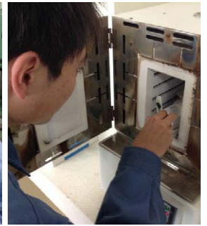
材料技術に関する学科の機能性材料(サーミスタ)を製作する実習
