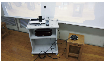
▲カメラは床上60cmの高さに設置され、児童同士の視線が合うようになっている
