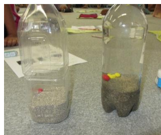
液状化の仕組みの実験1
