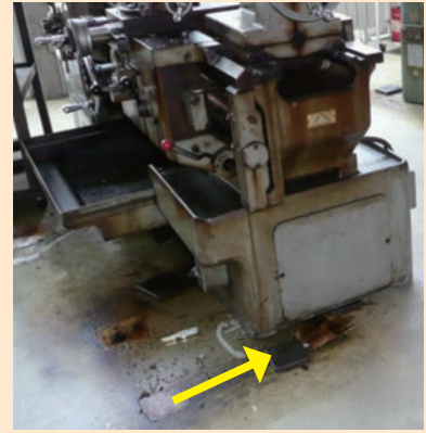
写真2. 地震による移動の例
