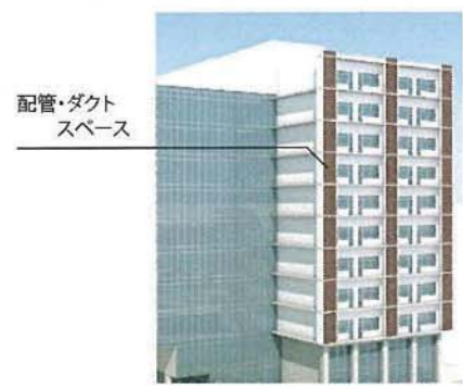
図3. 外壁配管・ダクトスペース
