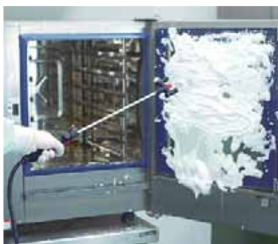
発泡装置で洗浄剤を塗布している例
