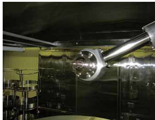
羽の取り付け部分からS Eが検出
