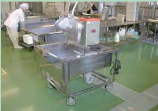
切裁機を移動台車に載せて可動式にした
