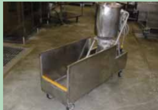
ミキサーを移動台車に載せて可動式にした
