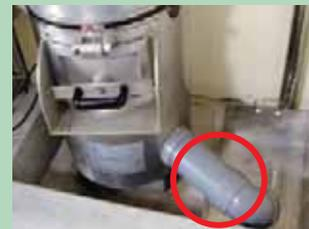
排水管を延ばすことで、排水による水の飛散を防止
