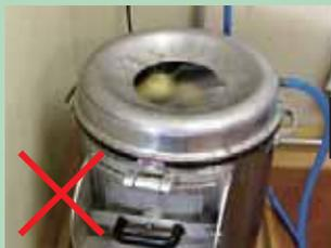
球根皮剥機に蓋がないため、周囲に洗浄水が飛散
