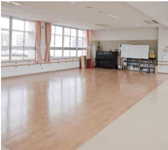
⑧ 多目的スペースは、普通教室の2教室分の広さを確保し、将来、児童生徒数が増加した場合の転用に配慮している。床は普通教室と同じ素材にしている。
