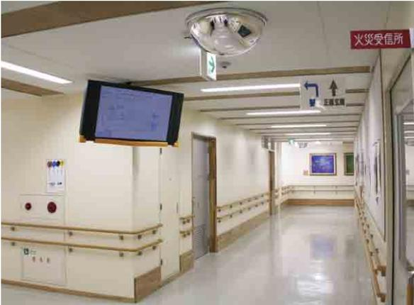
④ 聾学校の廊下の曲がり角には衝突防止のため、カーブミラーが設置されている。また、校内に様々な情報を視覚的に伝えるためのディスプレイが多数設置されている。
