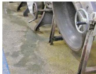
揚げ物機、焼き物機、回転釜周辺の汚れは、油汚れや様々な食品による複合的な汚れで、いわば「ガンコ」な汚れです。中性洗剤、アルカリ洗浄剤など、汚れの度合いに応じた洗浄剤を使用して洗浄します。特に汚れが目立つ部分はアルカリ洗浄剤をつけたブラシでこすり洗いしましょう。
