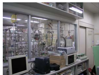
奥の実験室と手前の執務空間を区画し、化学物質等のばく露を低減している。
