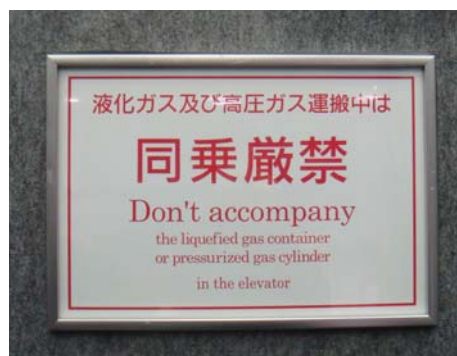
エレベーター内の液化ガス及び高圧ガスボンベとの同乗禁止の表示
