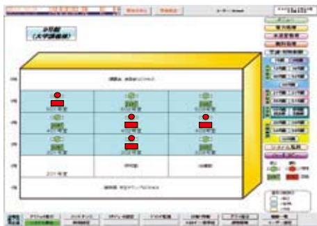
教室の空調・照明制御
