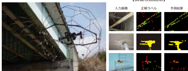
研究開発中の自律飛行ドローン及び深層学習に基づくインフラ構造物の損傷箇所自動検出技術 （提供：理化学研究所、東北大学）
