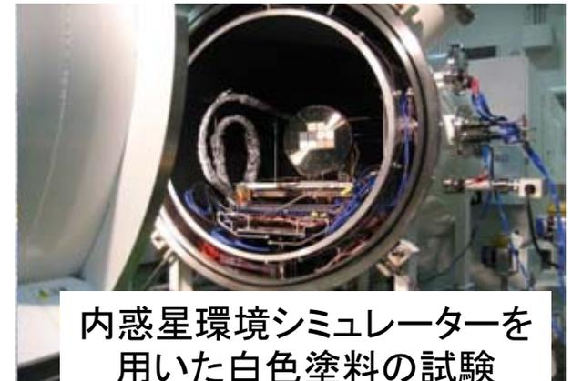
内惑星環境シミュレーターを用いた白色塗料の試験
