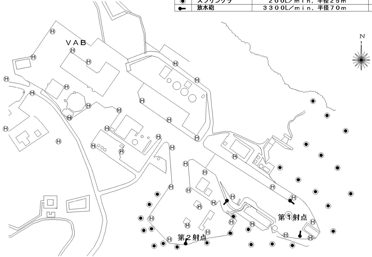
図-5 吉信射点消火設備配置図
