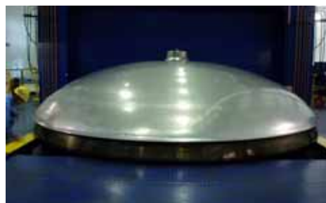
タンクドーム スピニング成形 概要
