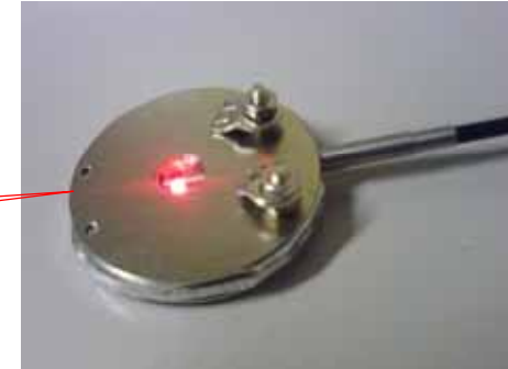
走査型原子間力顕微鏡の試料ホルダー 光ファイバーにより太陽電池への光照射 を可能としている。
