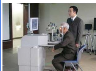
遠隔操作型細隙灯顕微鏡
