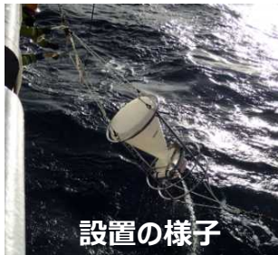
係留系による定点鉛直観測 (水深～2,000m) 生物、化学、物理など観測 目的に応じて測器を構成
