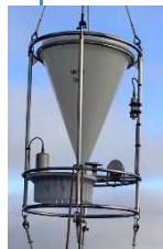
係留系による定点鉛直観測 (水深～2,000m) 生物、化学、物理など観測 目的に応じて測器を構成
