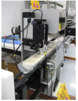
マルチセンサーコアロガーを用いたコア試料の分析例
