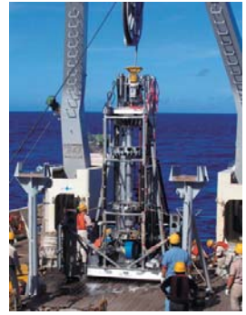
着座式掘削装置の例(日油技研工業株式会社のウェブサイトより)
