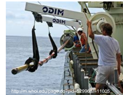
ウッズホール海洋研究所の研究船Knorrに搭載されている45m級ピストンコーラー
