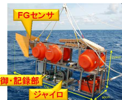
チタン製曳航フレーム (千葉大)
