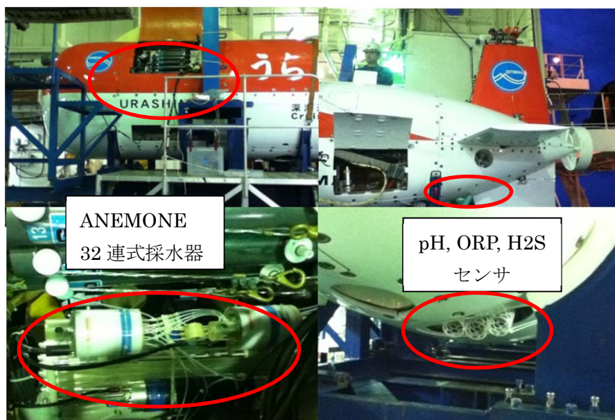
図 5：うらしまでの実証試験。採水器は 32 連式で運用。
