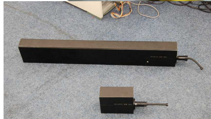
上: プロジェクター(ナロービーム: 実開口インタフェロメトリ) 下: プロジェクター(ワイドビーム: 合成開口インタフェロメトリ)
