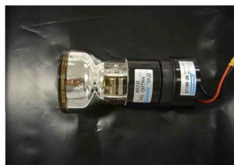
光電子増倍管(浜松ホトニクス製R6233)
