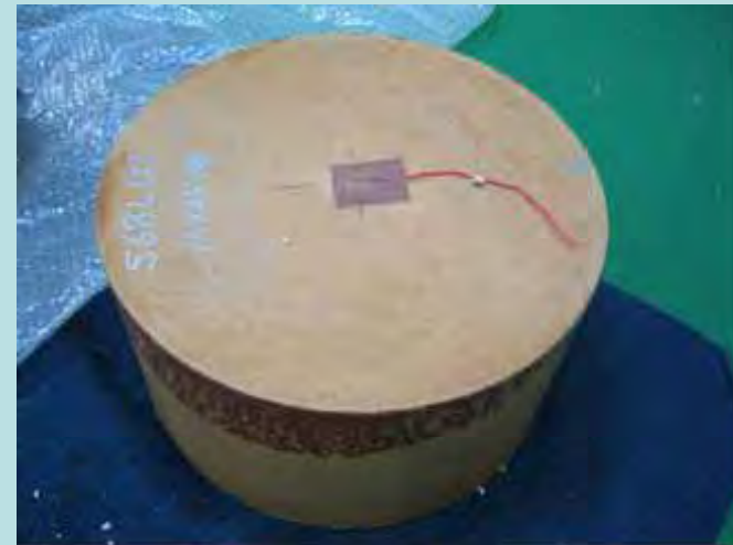
JAMSTEC開発品 (146Mpa: 圧壊なし)
