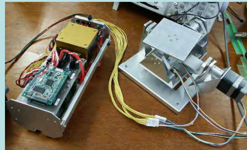
新たに開発した船上用通信制御装置：ギャップフィラー法はアップリンクに地上中継局を用いるため陸上との近距離通信が必要。この他に陸上との通信アンテナを開発中。
