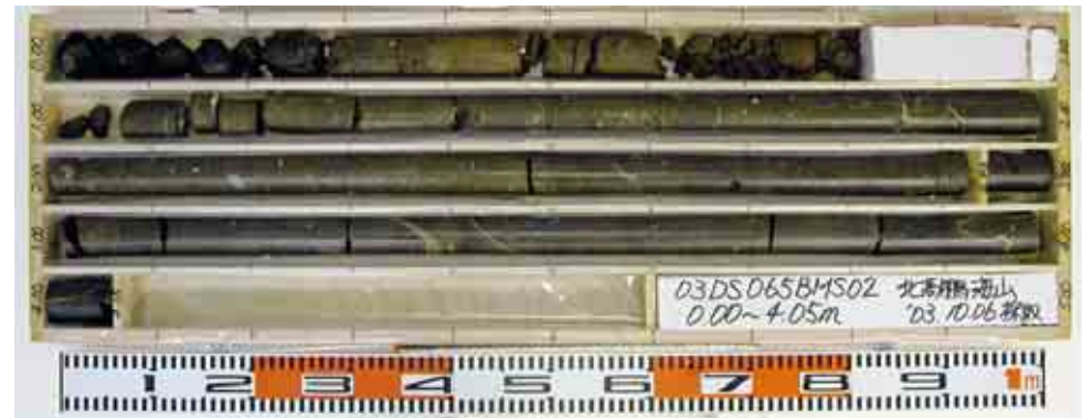
BMSによって採取したコアサンプル
