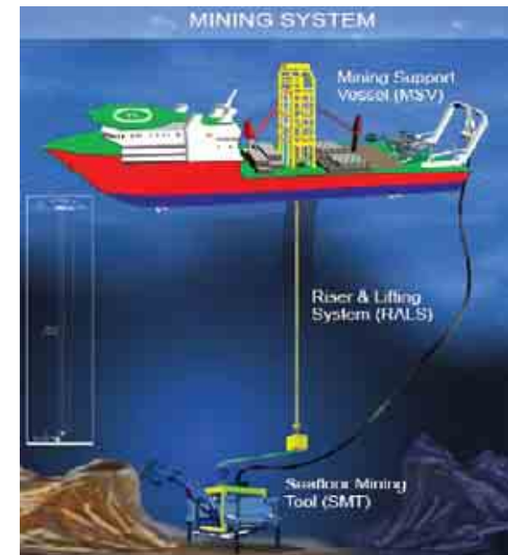
ノーチラス社 採鉱システム概念図
