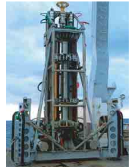
ボーリングマシン(BMS)
