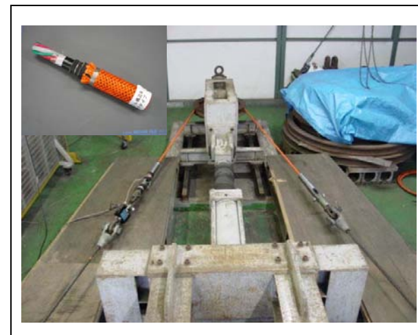
高強度ケーブルの疲労試験 (左上:開発ケーブルの構造)
