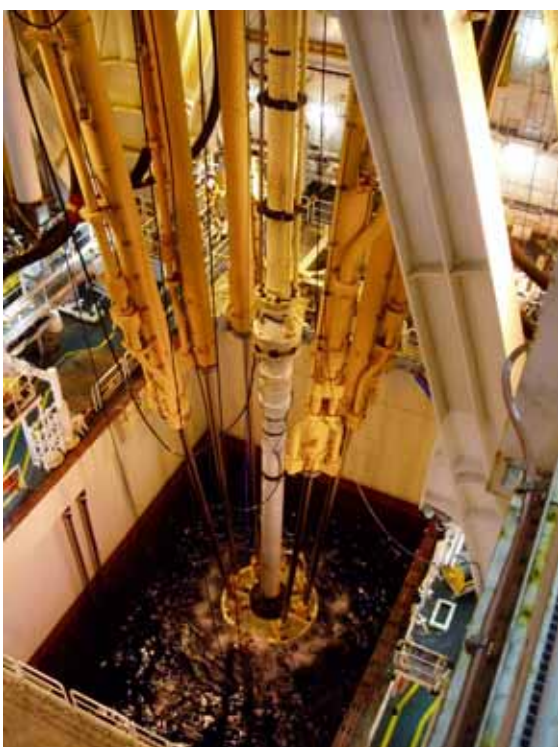
写真-1 ライザーテンショナー (6本のライザーテンショナー(黄色)が中央のライザーパイプ(白色)を保持する)
