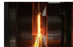
地震時の高速断層すべり運動を再現した岩石摩擦実験
