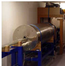
(4) 超伝導磁力計: 残留磁化の自動測定
