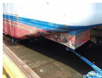
津波損傷復旧対応
