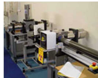
(5) マルチセンサーコアロガー: 物性値の非破壊自動測定
