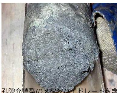
孔隙充填型のメタンハイドレートを含む砂試料 (東部南海トラフで採取)
