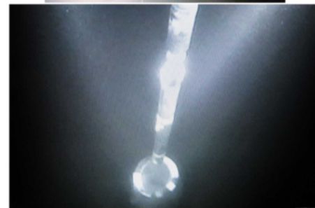
図 19 掘削孔に設置した長期孔内計測システム
