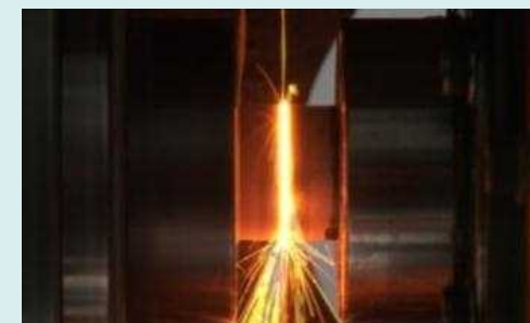
地震時の高速断層すべり運動を再現した岩石摩擦実験
