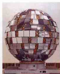
測地衛星「あじさい」 直径215cm、重量685kg、高度1500kmの軌道を周期約2時間で地球を周回しています。 昭和61年宇宙開発事業団によって打ち上げられました。
