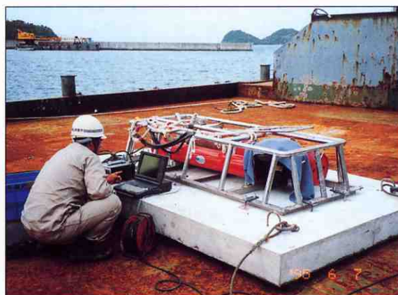
海底設置型の超音波流速計
