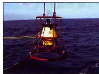
海底地殻変動観測装置の投入風景
