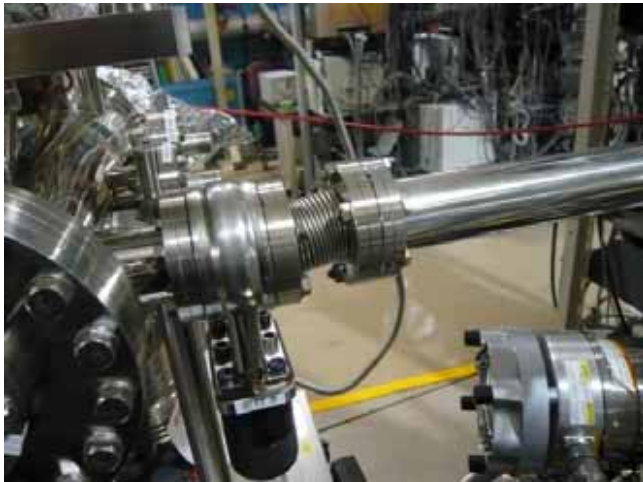
接合部分の変形
