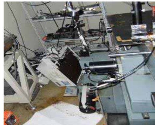
回折実験装置の転落
