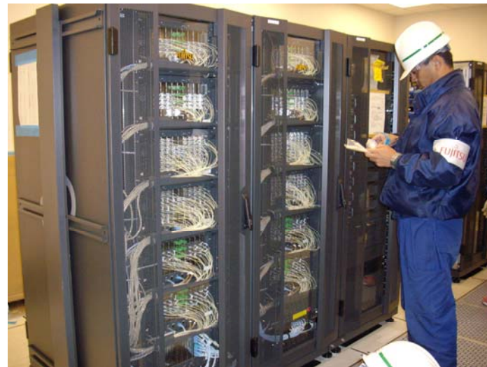
チリ現地山頂施設(標高5,000m)に設置された ACA用高分散相関器
