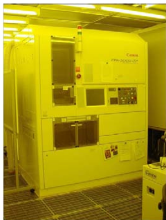
縮小投影露光装置による素子製造
