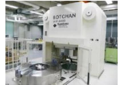
世界最大超高压合成装置「BOTCHAN」
