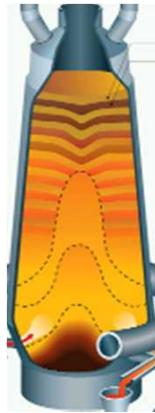
現象のメカニズムの数理モデル化により結果から原因を推定する「逆問題」という数学的手法を利用して、製鉄高炉における温度変化を数理モデル化した。
